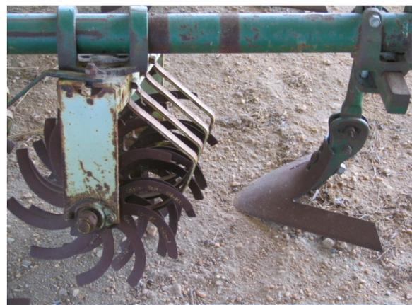
Figure 11. Rolling unit plus sweep
